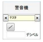
**▲ テスタ ▶** を切り替え操作して、**警音器**の検査入力を選択します。 選択肢は**テスタ、聴感**の 2 種類です。
