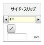
**●** を切り替え操作して、**サイド・スリップ**の検査入力を選択します。 選択肢は**イン、アウト、(空欄)**の3種類です。(空欄)は入力が**0**のときに使用します。
